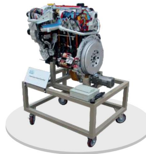
A20: MODELO DE DEMOSTRACIÓN DE LA SECCIÓN DEL MOTOR DIÉSEL
